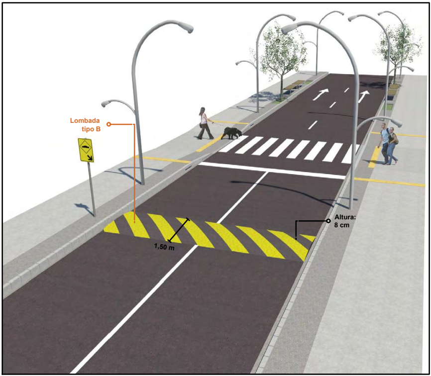
DETALHE LOMBADA TRANSVERSAL TIPO B
