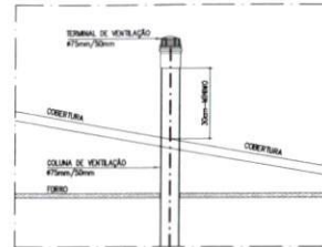
DETALHE TÍPICO EXTREMIDADE SUPERIOR DA COLUNA DE VENTILAÇÃO ESC 1/50
